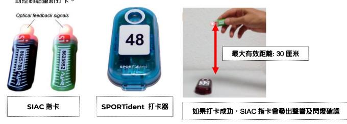
根據廠方資料,如果指卡沒電,指卡將不能使用隔空打卡功能。如果指卡在打卡器 30 厘米範圍內皆無閃燈或聲響, 請將指卡當成普通 SI 卡使用(即將指卡直接接觸打卡器)。賽員不能以系統失效作為抗辯理由。
