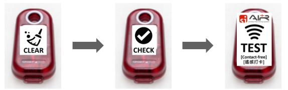
SPORTident Air+ 是指卡和打卡器毋須接觸的電子計時系統。是次賽事中,打卡器和 SIAC 指卡的有效範圍為 <u>30</u> <u>厘米(約一個定向燈籠的大小)</u>。如果打卡成功, SIAC 指卡會發出聲響及閃燈確認。如果沒有以上訊號,賽員須回 到控制點重新打卡。
